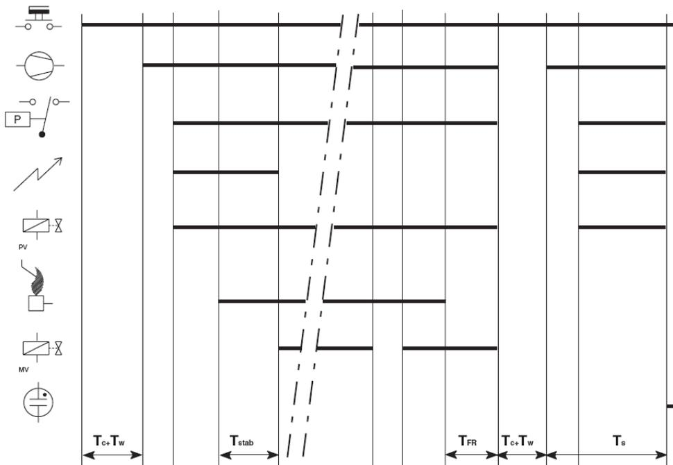
Рис. 44. Диаграмма синхронизации регуляторов розжига S4565DF и TF
