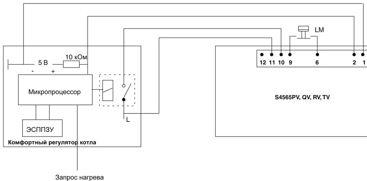
Рис. 58. Назначение выходного сигнала состояния
