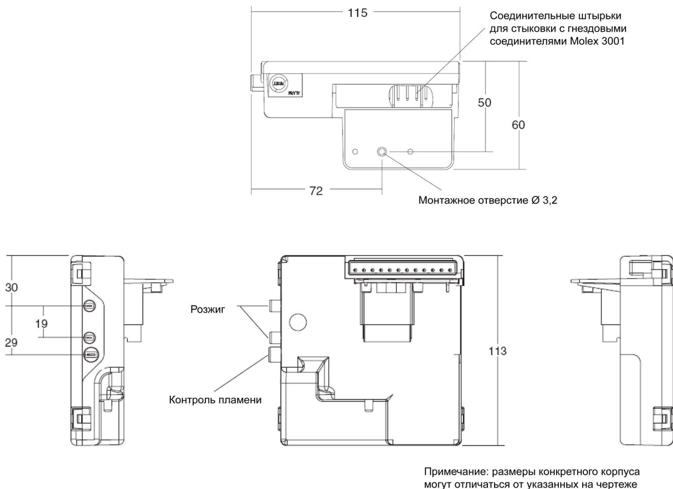
Рис. 1. Размерный чертеж корпуса (размеры в миллиметрах)
