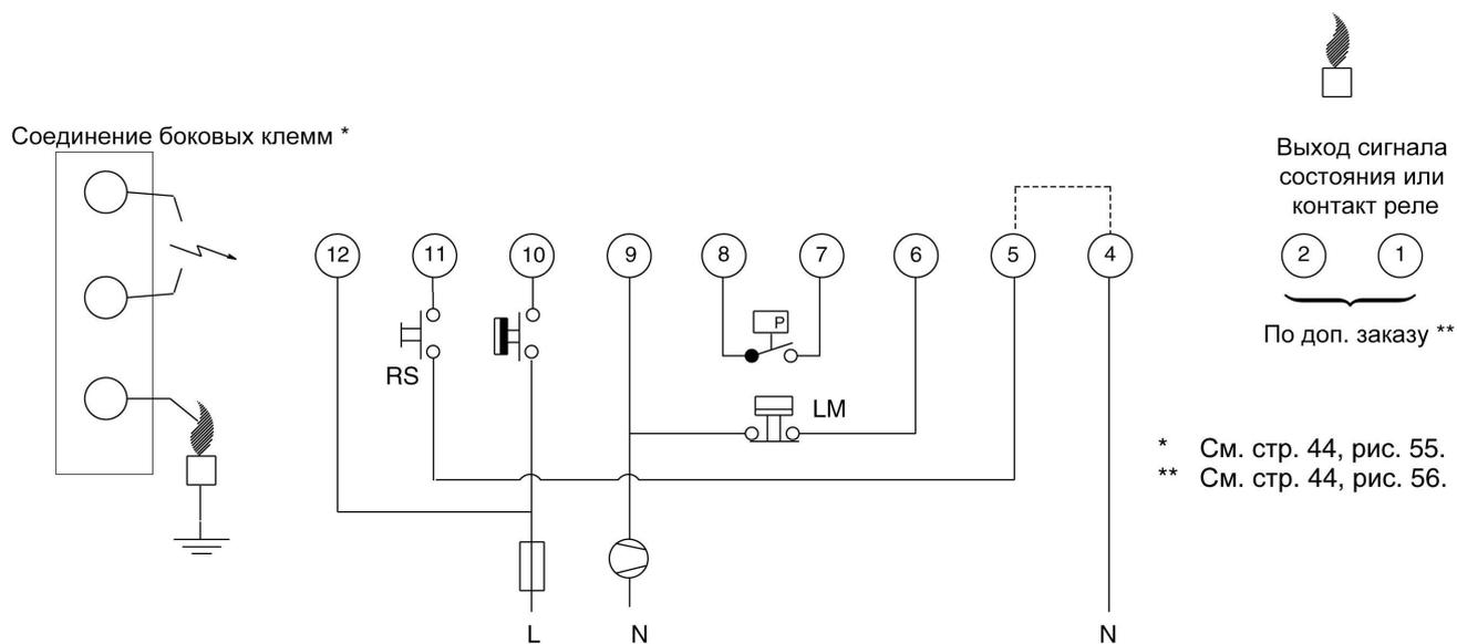
Рис. 52. Схема соединений регуляторов розжига S4565RV и TV
