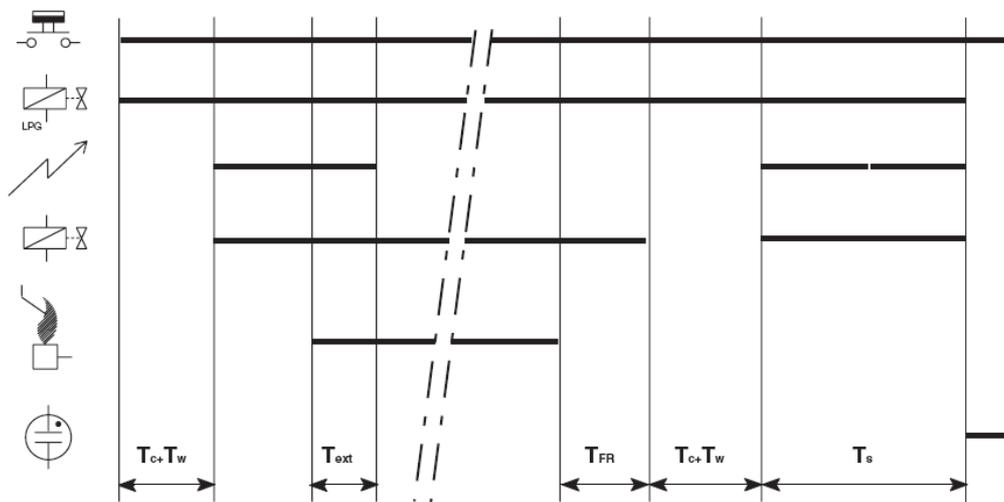
Рис. 41. Диаграмма синхронизации регуляторов розжига S4565AF и PF
