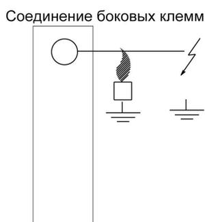
**Рис. 32.** Вариант соединения боковых клемм в случае объединенной системы контроля пламени и искрового разряда (один стержень)
