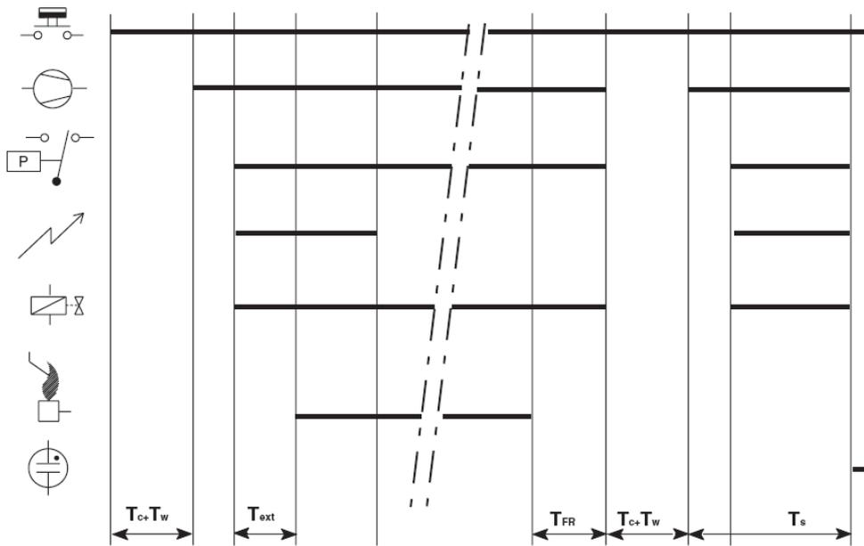
Рис. 43. Диаграмма синхронизации регуляторов розжига S4565CF и RF
