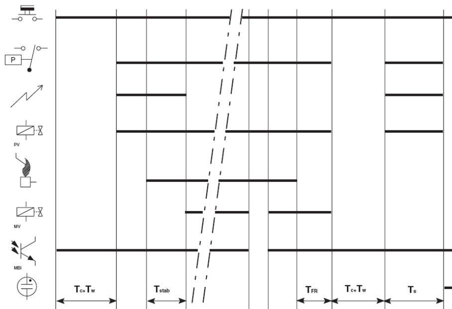
Рис. 50. Диаграмма синхронизации регуляторов розжига S4565DF и TF с внешним прерыванием главной горелки в атмосферных применениях
