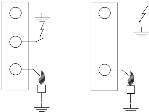
Рис. 17. Вариант соединения боковых клемм в случае искровых разрядов на землю
