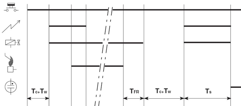
Рис. 20. Диаграмма синхронизации регуляторов розжига S4565AD, PD серии "1000"
