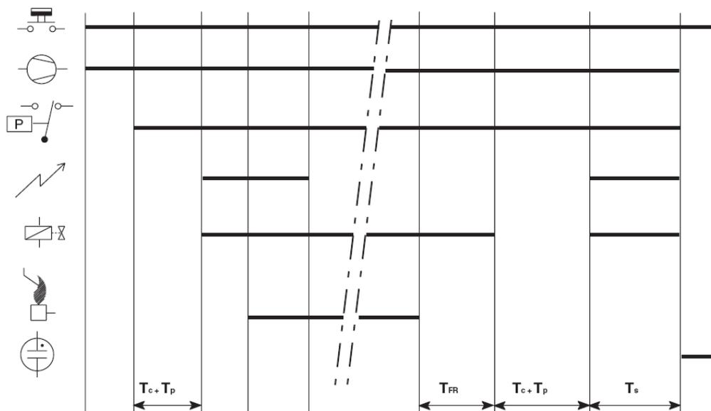
Рис. 9. Диаграмма синхронизации регуляторов розжига S4565C и R
