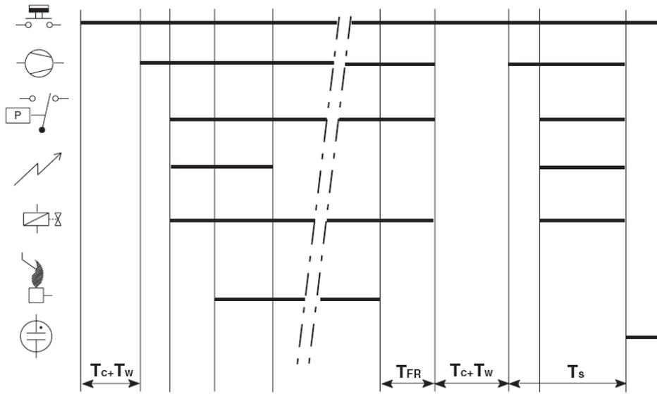
Рис. 37. Диаграмма синхронизации регуляторов розжига S4565CD, RD серии "2000"
