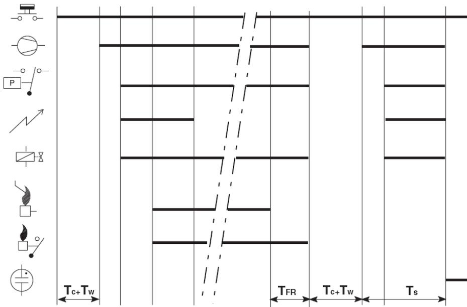
Рис. 38. Диаграмма синхронизации регуляторов розжига S4565DD, TD серии "2000"
