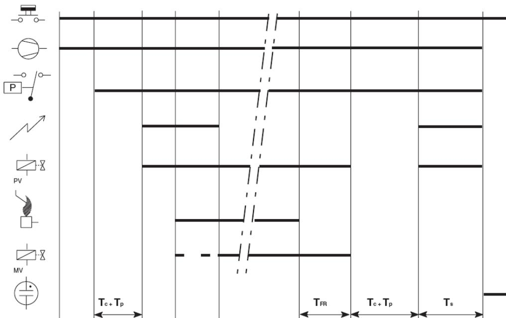
Рис. 10. Диаграмма синхронизации регуляторов розжига S4565D и T
