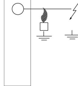
Рис. 18. Вариант соединения боковых клемм в случае объединенной системы контроля пламени и искрового разряда (один стержень)
