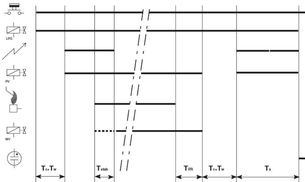
Рис. 42. Диаграмма синхронизации регуляторов розжига S4565BF and QF
