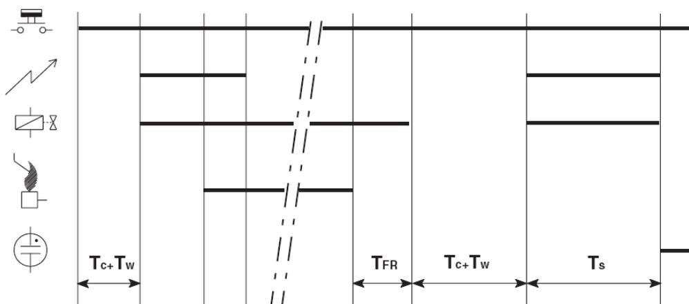
Рис. 35. Диаграмма синхронизации регуляторов розжига S4565AD, PD серии "2000"
