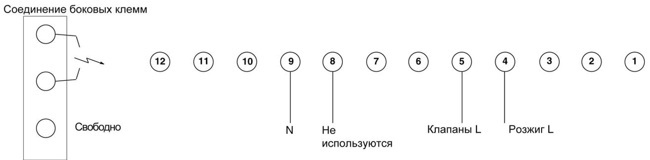
Рис. 30. Схема соединений регуляторов розжига S4565SD серии "2000"
