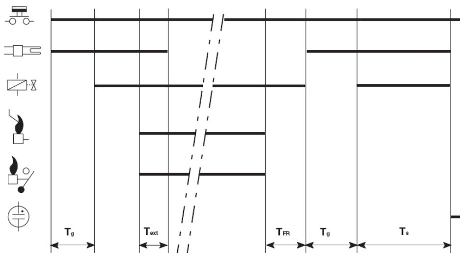
Рис. 68. Диаграмма синхронизации регуляторов розжига S4575B, Q
