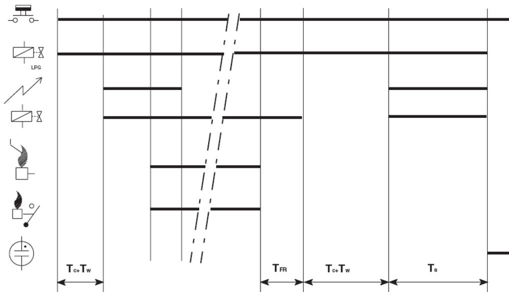
Рис. 36. Диаграмма синхронизации регуляторов розжига S4565BD, QD серии "2000"
