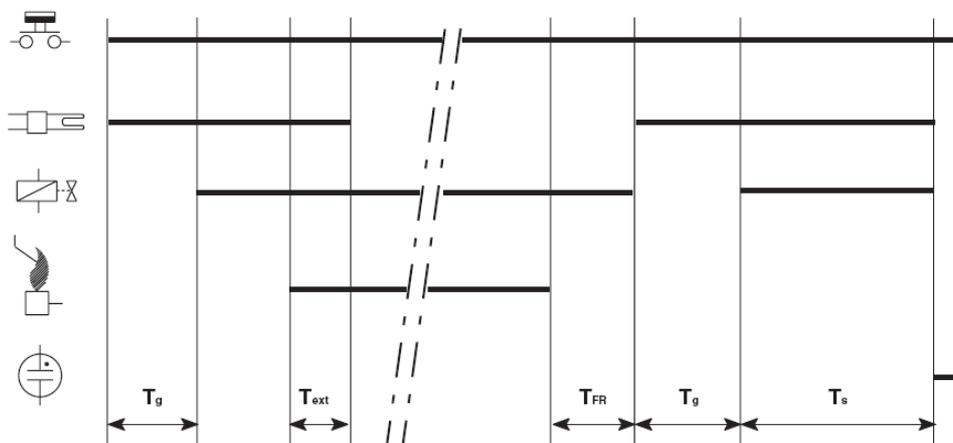
Рис. 67. Диаграмма синхронизации регуляторов розжига S4575A, P
