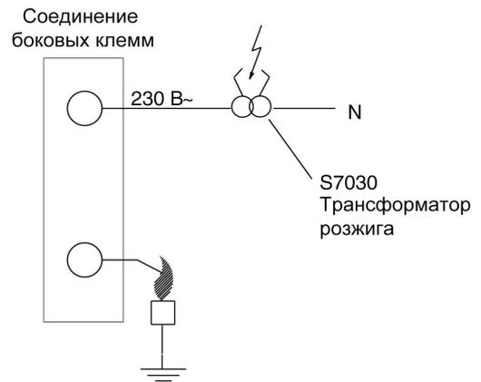
**Рис. 72. Вариант соединения боковых клемм для моделей с входом контроля пламени + выход 230 В~ для внешнего трансформатора розжига S7030**
