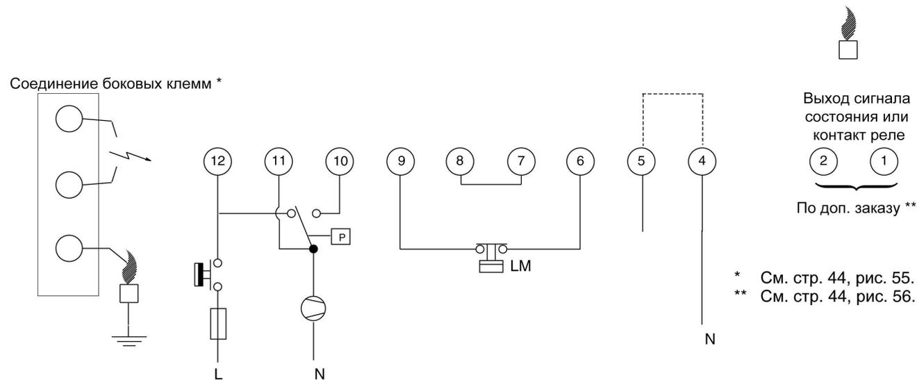
Рис. 53. Схема соединений регуляторов розжига S4565RV и TV с дополнительной предварительной продувкой
