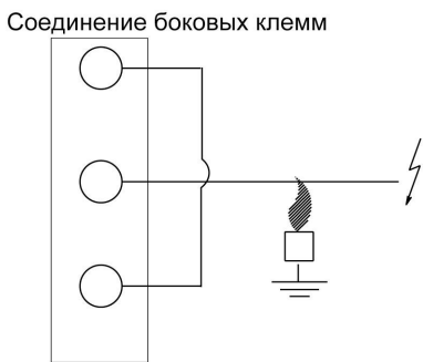
Рис. 53. Схема соединений регуляторов розжига S4565RV и TV с дополнительной предварительной продувкой
