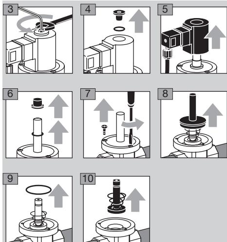
▷ Проверьте запирающую пружину на предмет повреждений.
