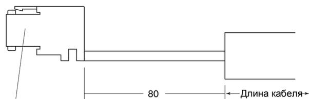
3-контактный соединитель RAST 5
