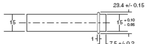
Рис. 9. Конец трубы для соединения с уплотнительным кольцом
