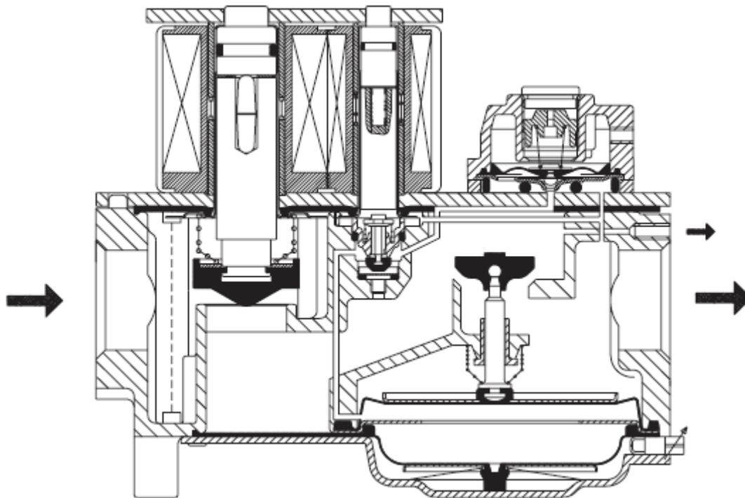
Рис. 14. Серворегулирование давления
