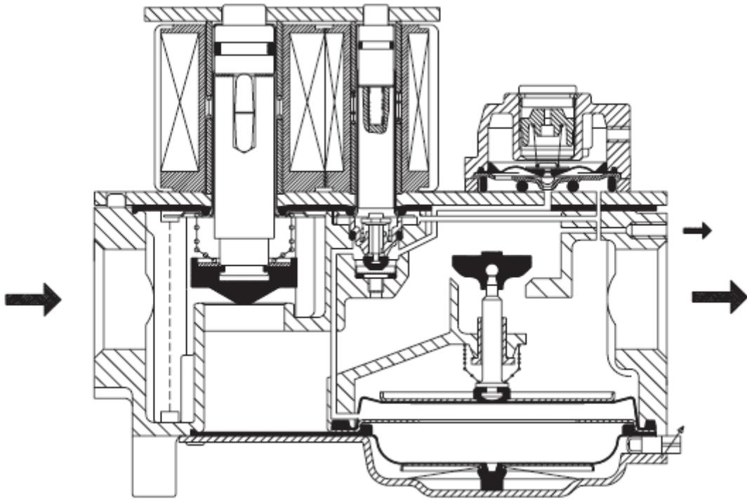
Рис. 17. Открытое положение предохранительного и главного клапанов
