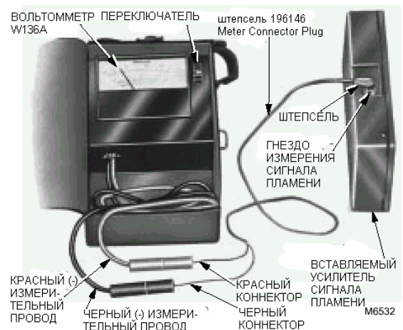
Рисунок 11. Измерение сигнала пламени в мкА
