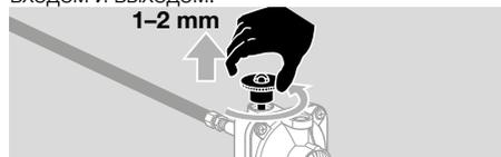
3 Удерживайте крышку рычага деблокировки в этом положении до окончания процесса выравнивания давления, после чего станет возможным вытянуть рычаг без усилий еще дальше.
