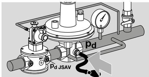
→ При достижении заданного давления срабатывания JSAV закрывается.
