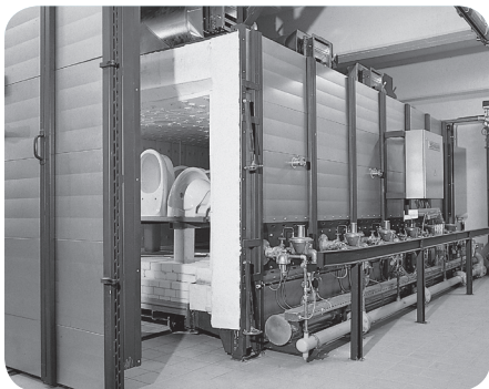
Печь периодического действия в керамической промышленности
