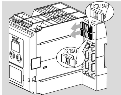
5 Проверьте работоспособность слаботочного предохранителя F1 или F2.
