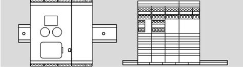
→ При вертикальном расположении DIN-рейки необходимо устанавливать концевые скобки (напр., Clipfix 35 производства Phoenix Contact) во избежание сползания ВСУ.
