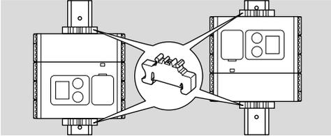
→ Автомат следует устанавливать в чистом месте (напр., в шкафу управления) со степенью защиты  $\geq$  IP 54. Образование конденсата не допускается.
