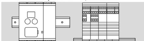
→ При вертикальном расположении DIN-рейки необходимо устанавливать концевые скобки (напр., Clipfix 35 производства Phoenix Contact) во избежание сползания FCU.
