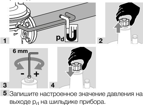
5 Запишите настроенное значение давления на выходе  $p_d$  на шильдике прибора.
