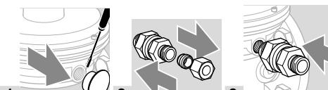
**4** Наденьте монтажную гайку и зажимное кольцо на импульсную линию.
