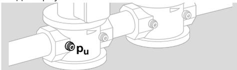
→ Используйте только допущенные уплотнительные материалы для герметизации соединений труб.
