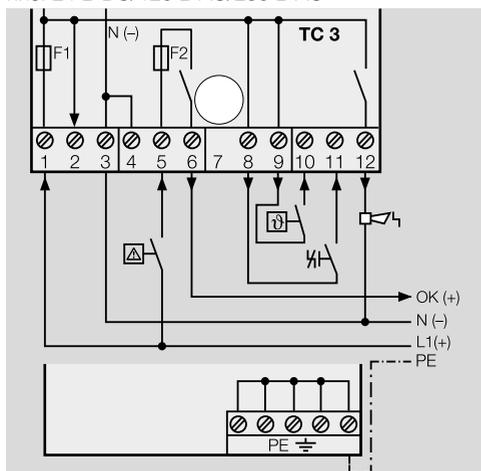
Напряжение питания: 120 В AC/230 В AC, управляющее напряжение: 24 В DC
