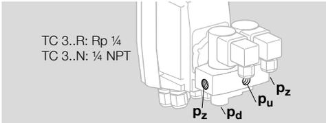
→ Используйте для соединения трубопровод 12 x 1,5 или 8 x 1.
