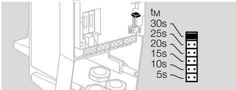
→ Без переключки: пропадание функции. LED сигнала работы  $\text{C}$  постоянно горит красным цветом, см. стр. 9 (9 Помощь при неисправностях).
