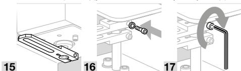
→ Теперь передвиньте рычаг затвора на достаточное расстояние от рычага сервопривода, так чтобы между ними могла поместиться гайка, как на рис. **15**. После этого рычаг дискового затвора можно привинтить.
