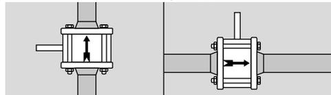
Для дисковых затворов с ограничителями (DKR..A) рекомендуется установка на вертикальном трубопроводе с направлением потока снизу вверх, чтобы предотвратить возникновение конденсата и накопление грязи на ограничителе.
