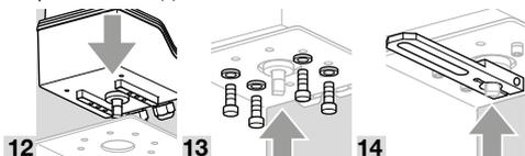
→ Прежде чем затянуть винты, которые крепят рычаг сервопривода, убедитесь, что рычаги выровнены параллельно друг к другу.
