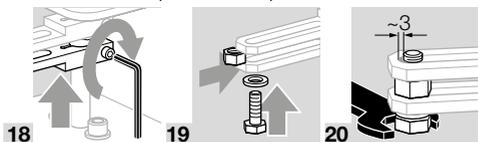
→ Винт, на который крепится рычаг сервопривода, не должен входить в паз до упора. Зазор прибл. 3 мм обеспечивает беспрепятственное движение рычага.
