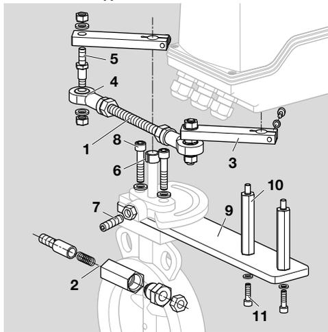
**1** Резьбовая тяга, 2 гайки (без демпфера)
