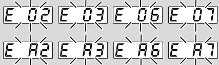
**? Пуск – пламя горит – несмотря на это дисплей мигает и отображает E 02 или E 03 для запальной горелки/горелки (горелка 1) или E 06 или E 07 для основной горелки (горелка 2).**
