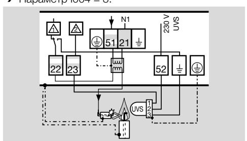
**Запальная горелка – одноэлектродная схема управления/основная горелка – UVC 1:**
