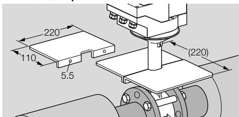
При температуре среды > 250 °C (482 °F) для защиты от перегрева используйте теплозащитную пластину.
