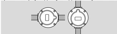
→ Корпус не должен касаться стены, мин. расстояние 20 мм (0,79").
