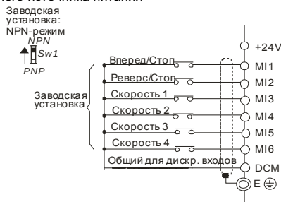
Рисунок 7. Выбор логики управления дискретными входами микропереключателем Sw1.
