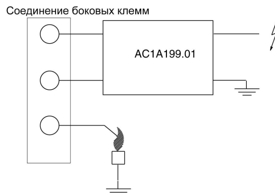
Рис. 57. Вариант соединения боковых клемм в случае внешнего устройства розжига AC1A199.01
