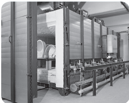
Печь периодического действия в керамической промышленности
