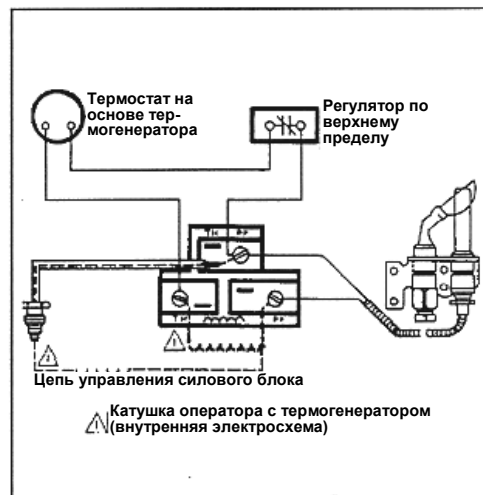
РИС. 11 – ТИПОВАЯ СХЕМА ЭЛЕКТРИЧЕСКИХ СОЕДИНЕНИЙ ДЛЯ УСТРОЙСТВА С ОПЕРАТОРОМ С ТРЕМЯ ВЫХОДАМИ
