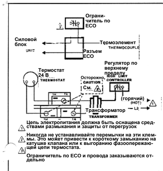
РИС. 9 ТИПОВАЯ СХЕМА ПОДКЛЮЧЕНИЯ ДЛЯ СИСТЕМ 24 В
