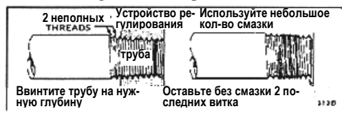
РИС. 5 – ИСПОЛЬЗУЙТЕ УМЕРЕННОЕ КОЛИЧЕСТВО КОМПАУНДА ДЛЯ ТРУБ.
