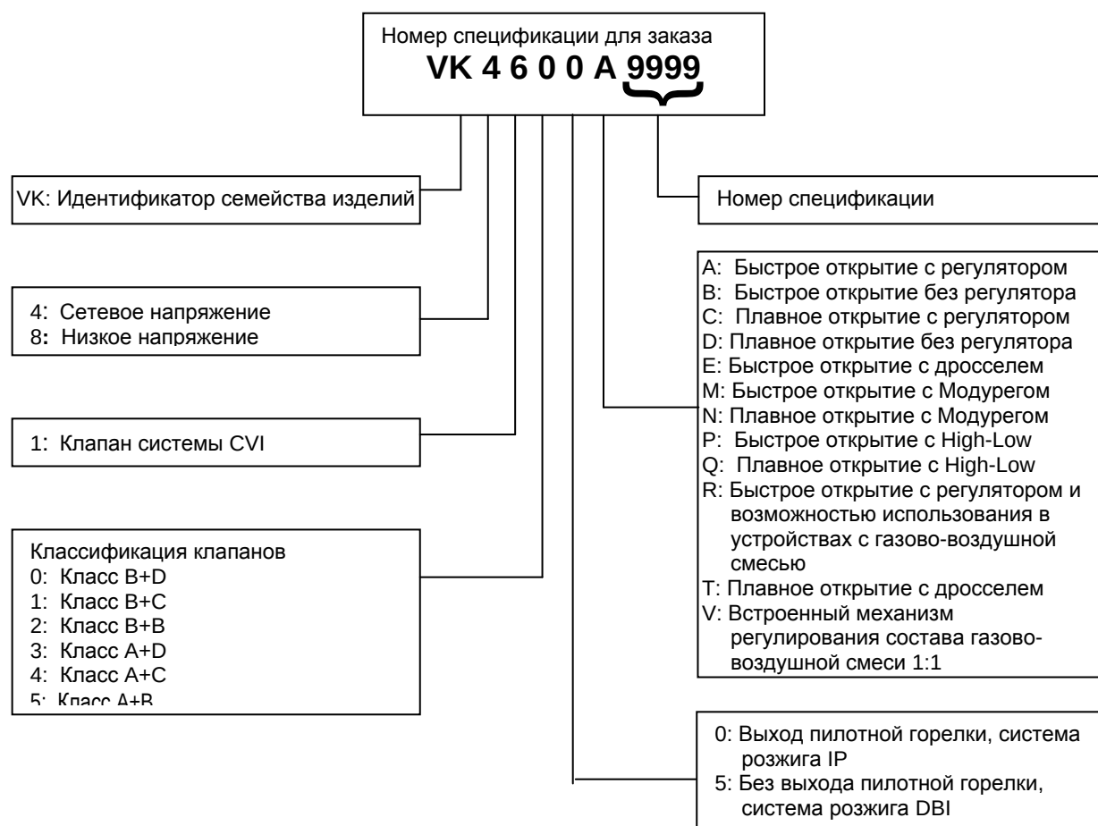
Рис. 19. Схема номера модели газовых регуляторов серии VK
