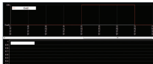
Графические тренды. Данные различных аналоговых и дискретных устройств (с типами данных BIT, WORD, DWORD, REAL и т.д.) из памяти ввода-вывода и других областей памяти можно сгруппировать и контролировать вместе в одном окне для поиска неполадок с учетом контекста. Можно настроить скорость выборки, а также диапазоны по осям X и Y (время и данные).
