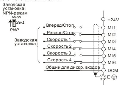
Рисунок 7. Выбор логики управления дискретными входами микропереключателем Sw1.
