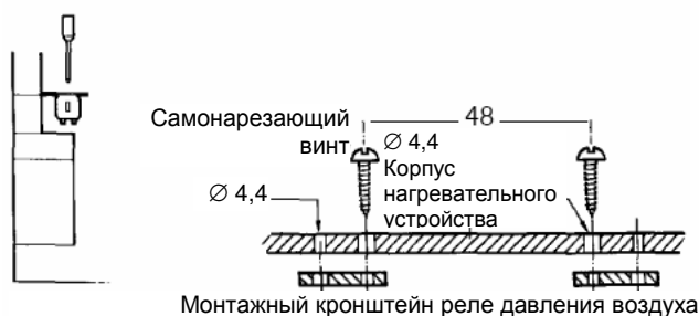
Рис. 9. Заднее крепление и монтажные размеры
