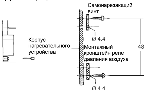
Рис. 8. Переднее крепление и монтажные размеры
